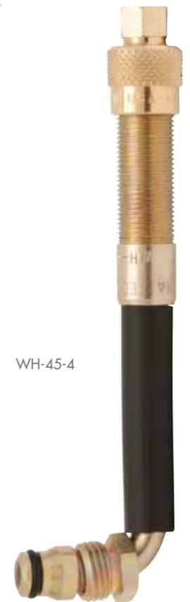
Se puede ordenar cualquier otra longitud. Toda válvula está equipada con un núcleo y tapa hexagonal. Para medidas sobre 6", se suministran 2 tuercas de bloqueo.
