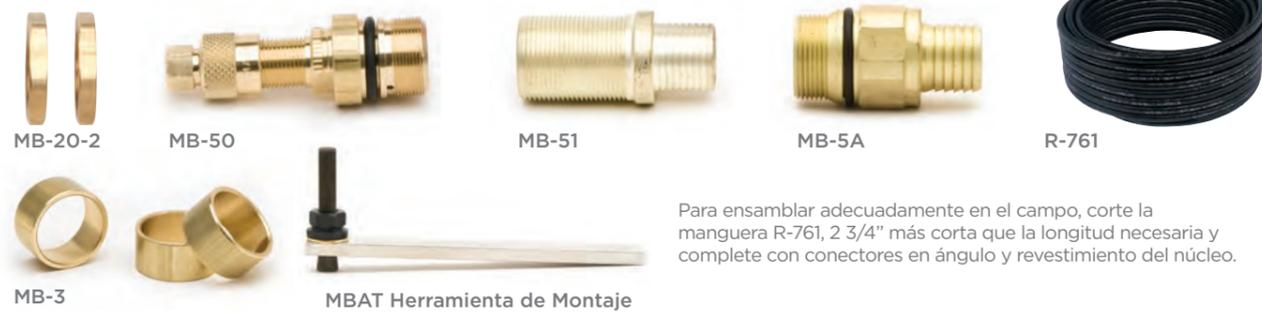
Para ensamblar adecuadamente en el campo, corte la manguera R-761, 2 3/4" más corta que la longitud necesaria y complete con conectores en ángulo y revestimiento del núcleo.
