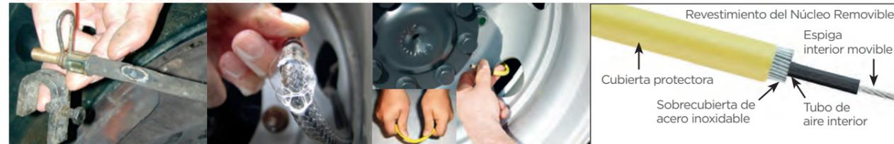
Extensiones convencionales contienen la presión entera en la cámara de la extensión. Daño a la extensión a través de uso o accidente puede significar la pérdida de aire en la llanta.
